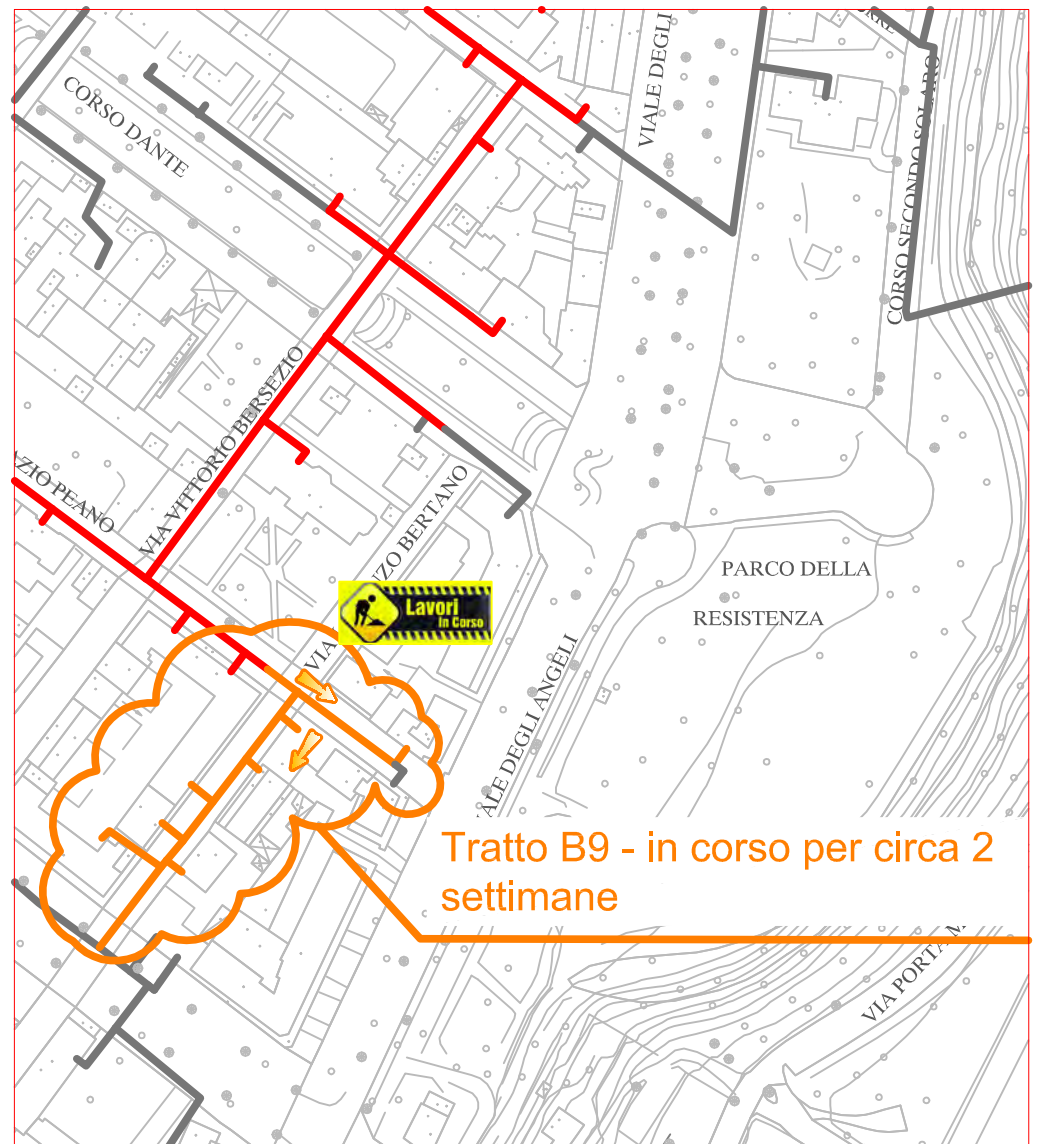
TRATTO DI SCAVO "B9"
